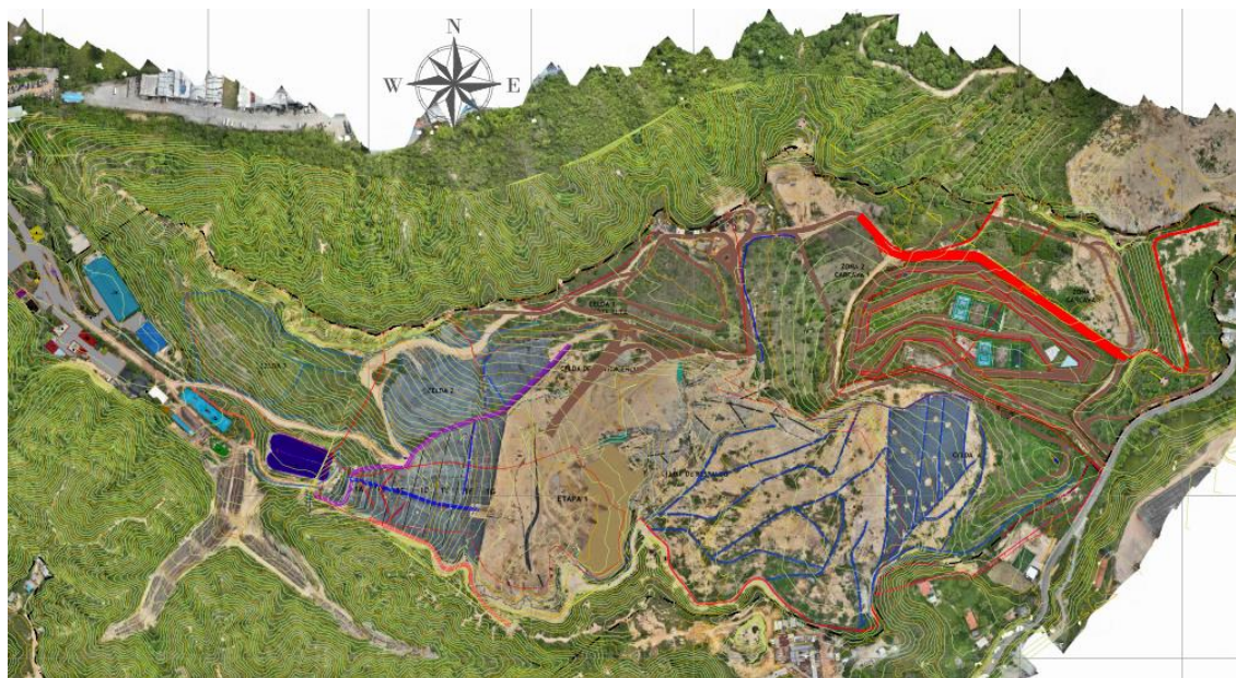
Figura 1 Panorámica del estado actual de los canales para la conducción de las aguas de escorrentía en El SDF “El Carrasco”
