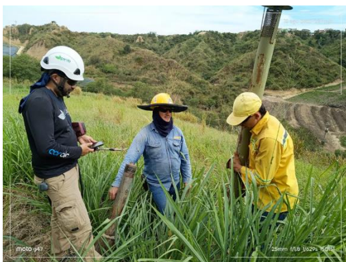
Ilustración 26 Monitoreo de la composición del Biogás y límite de explosividad LEL, agosto 2026
