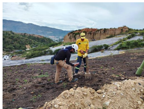
Ilustración 26 Monitoreo de la composición del Biogás y límite de explosividad LEL, agosto 2026
