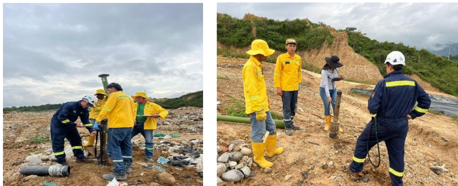
Ilustración 10 Monitoreo de la composición de biogás y límite de explosividad LEL, marzo 2026
