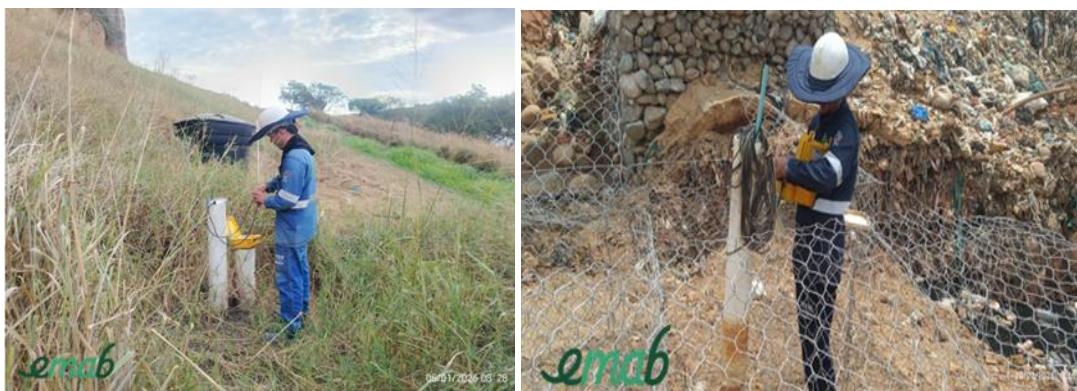
Ilustración 14 Lectura de Piezómetros de hilo vibrátil, periodo de enero y febrero de 2026
