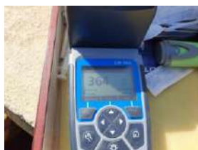
Medición de sólidos suspendidos totales (SST) en la entrada y salida DAF
