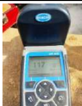
Medición de sólidos suspendidos totales (SST) en la entrada y salida DAF
