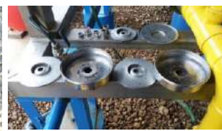
Inspección y limpieza de la bomba de recirculación de la bomba DAF
