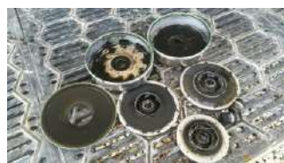
Inspección y limpieza de la bomba de recirculación de la bomba DAF
